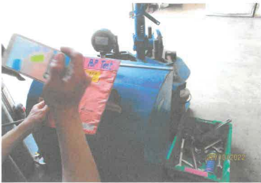
ตรวจสอบSafety Valve ต่างๆทำงานตามค่าที่กำหนด ด้วยเครื่องอัตโนมัติตรวจสอบการทำงาน หม้อไอน้ำหมายเลข 6( HRSG-05 ) บริษัทสหโคเจน (ชลบุรี) จำกัด(มหาชน) วันที่ 23 ตุลาคม 2565
